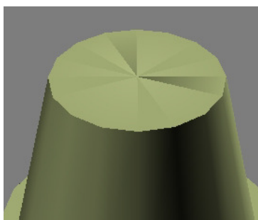
Obr. M - vliv parametru Weld Core na vzhled objektu. V tomto případě je Weld Core vypnuto.
